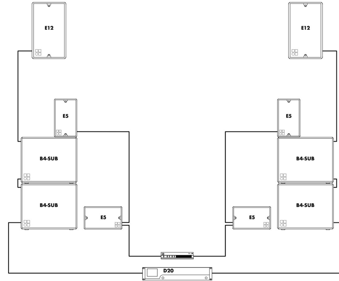
D20 Verstärker im Mix-TOP/SUB-Betrieb mit E12 Lautsprechern und B4 Subwoofern als leistungsstarkes PA-System sowie 5D Verstärker im Dual-Channel-Betrieb mit E5 Lautsprechern für das Nahfeld
