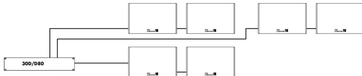
30D/D80 Verstärker in gemischter Konfiguration aus Dual-Channel-Betrieb für MAX2, M6, M4 und 2-Weg-aktiv-Betrieb für M6, M4 und M2
