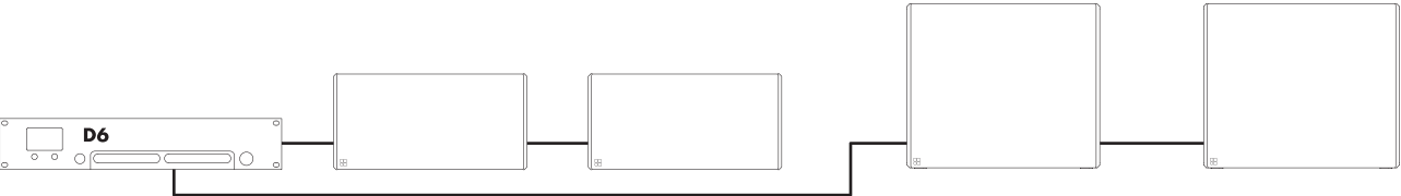
D6 数字功放在双通道 (Dual Channel) 模式下驱动10A, 10A-D, 10AL 或 10AL-D音箱以及18A-SUB 或 27A-SUB超低频音箱
