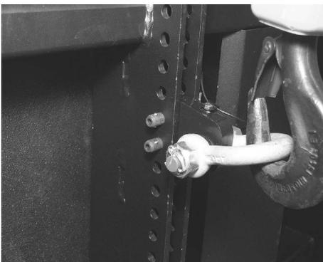
**Fig. 30: J Lastadapter montiert**
