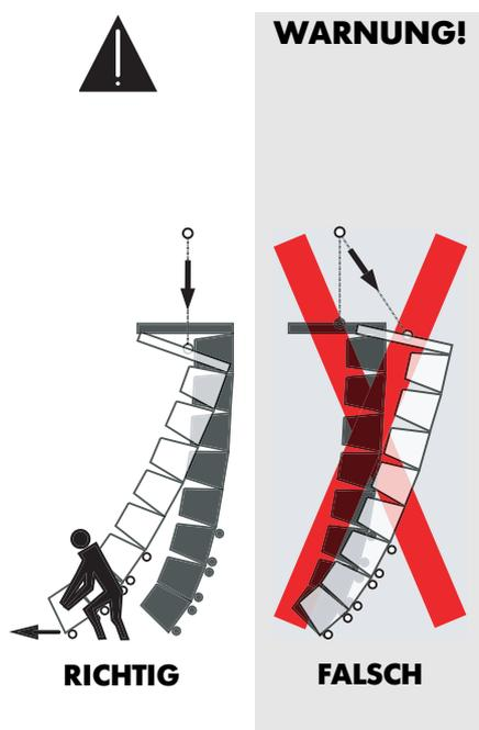
**Wird das Array an dieser Stelle weiter abgesenkt besteht die Gefahr, dass das Array, abhängig vom Untergrund (Hallenboden/Freigelände) zunächst immer weiter nach vorne kippt bevor es dann schlagartig nach hinten wegrollen kann.**
