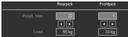
図 14: 2点吊り時の ArrayCalc の穴位置表示
