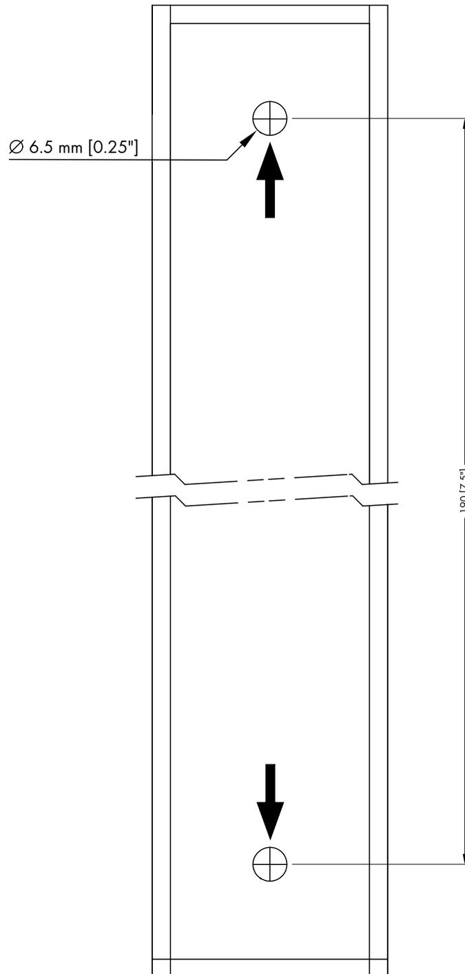
**Z5404 Schwenkbügel8S, Bohrschablone**
