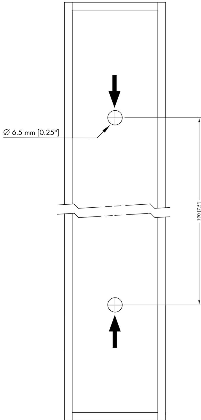
**Z5405 Schwenkbügel 10S, Bohrschablone**
