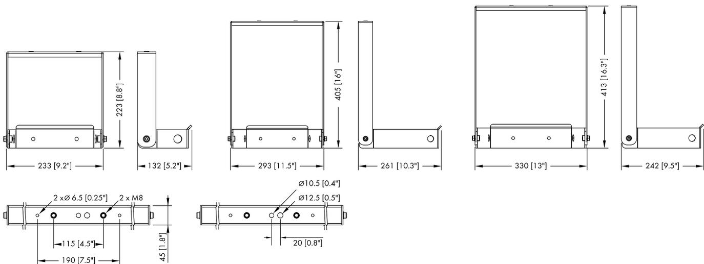
**Z5404/05/06 Schwenkbügel 8S/10S/12S, Abmessungen in mm [Zoll]**
