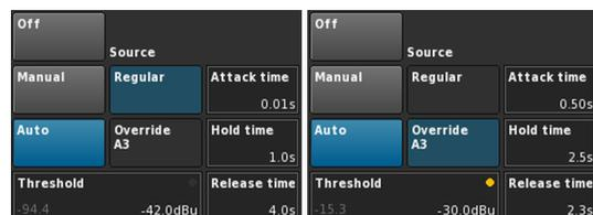
Sobald der Signalpegel den Schwellwert unterschreitet, wird der Eingang A3 stummgeschaltet, während die Stummschaltung bei allen anderen Kanälen wieder aufgehoben wird (Crossfade). Die Zeitspanne, in der dies erfolgt, wird über die "Hold time" und "Release time" festgelegt.
