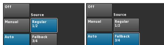
Nachdem die Fallback-Funktion ausgelöst wurde, kann sie manuell zurückgesetzt werden, indem die Eingangsquelle «Regular 1/2» wieder aktiviert (gewählt) wird.
