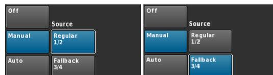
**Auto** Um den automatischen Wechsel auszulösen, muss Input monitoring («Mon») aktiviert und entsprechend parametrisiert sein. Der gewünschte Signalweg («Source») kann manuell ausgewählt werden, entweder lokal oder über die Web-Remote-Schnittstelle oder über das d&b Remote-Netzwerk mit R1.
