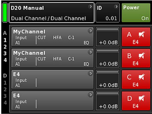
Ausgehend vom Home Screen (Startbildschirm) gliedert sich die Menüstruktur der Betriebssoftware in zwei Hauptachsen: das Gerätemenü (Device setup) und das Kanalmenü (Channel setup). Die Navigationsschaltflächen bieten direkten vertikalen Zugang zu den jeweiligen Untermenüs. Innerhalb eines Untermenüs sorgt die Reiterstruktur auf der rechten Seite für eine klare horizontale Struktur.
