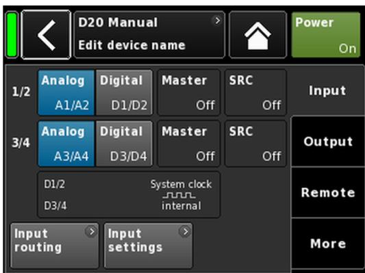
**2. Eingang (Eingangskonfiguration / Eingangsrouting)**
