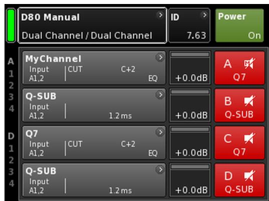
在主屏幕上，操作软件的菜单结构分为两条主线：设备设置和通道设置。通过导航按钮可直接纵向进入特定的子菜单，各子菜单右侧的选项提供清晰的横向顺序命令。
