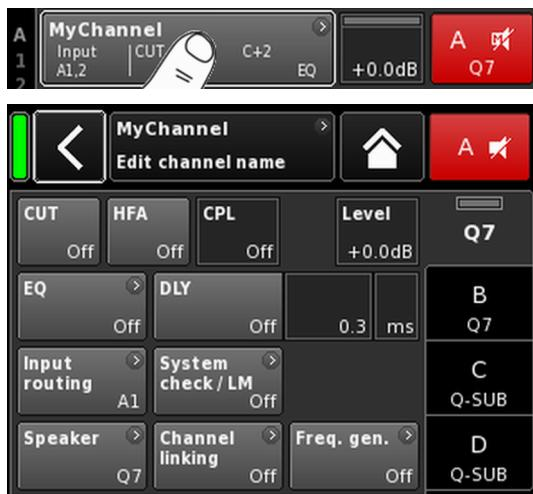
如果在主屏幕上选择特定通道，相应的通道设置屏幕自动打开，屏幕上的对应通道选项则激活。
