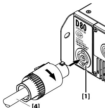
在设备连接电源前，应检查电源电压和频率是否与位于设备后面板电源连接插座相邻的铭牌标注值一致。
