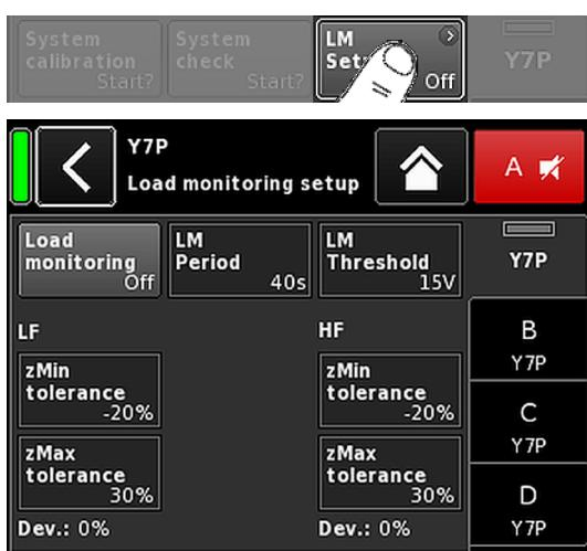
**Load monitoring 开/关** 激活 Load monitoring。开/关状态也显示在 System check 和 Channel setup 屏幕上。
