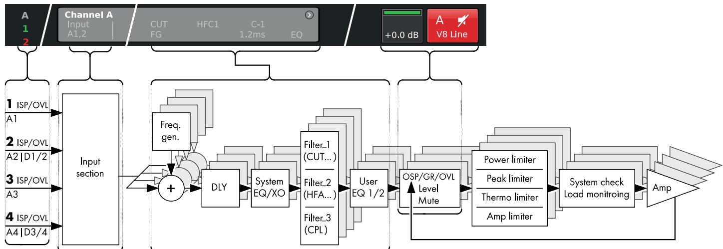
D80 通道链路方框图 (信号链)
