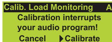
Auswahl von "Calibrate" startet die Kalibrierung. Deren Fortschritt wird angezeigt. Die Kalibrierung kann durch Drücken des Encoders zu jedem Zeitpunkt abgebrochen und ggf. wieder neu gestartet werden.
