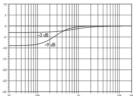
**Fig. 5: Corrección de la respuesta de frecuencia del circuito CPL**
