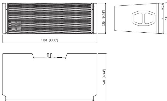
**Fig. 8: Dimensiones de la caja J8/J12 en mm [pulgadas]**
