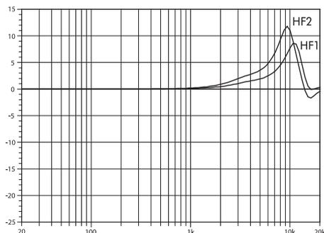
**Fig. 4: Corrección de la respuesta de frecuencia del circuito HFC, ajustes HF1 y HF2**
