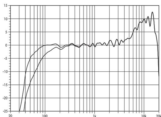
**Fig. 7: Respuesta de frecuencia de J8, una sola caja, estándar y ajustes de CUT**
