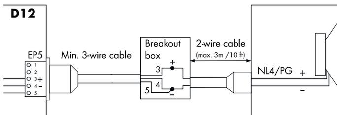
Bei Festinstallationen kann SenseDrive auch bei Lautsprechern mit NL4-Anschlüssen oder mit Festanschluss (PG) eingesetzt werden. Die Verbindung der negativen Signalleitung (EP5 Pin 4 des entsprechenden D12-Ausgangs) zur SenseDrive-Leitung (EP5 Pin 5 des entsprechenden D12-Ausgangs) erfolgt über eine Breakout-Box in der Nähe des Lautsprechers. Für die uneingeschränkte SenseDrive-Funktion sollte die Verbindung nicht mehr als 3 m vom Lautsprecher entfernt erfolgen.
