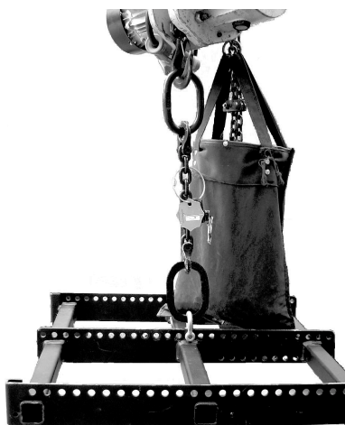
Fig. 6: Ajuste de la cadena del conector del elevador
