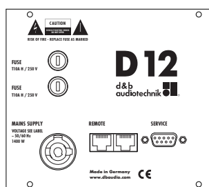
図 26: D12 電源パネル
