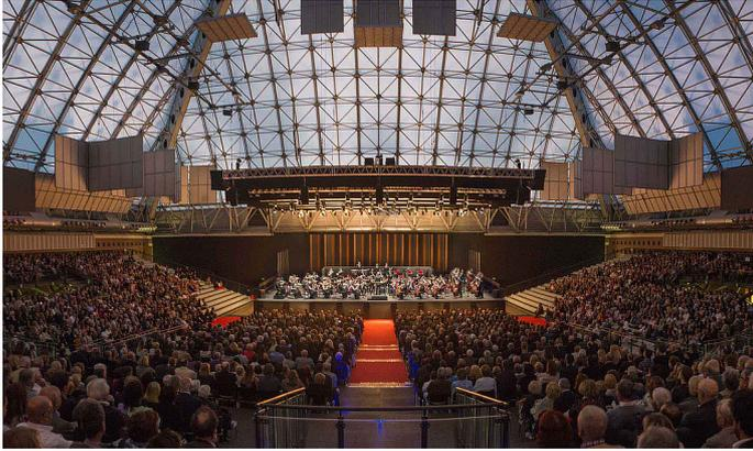
지붕은 방음이 된 것은 아니며 내부 노이즈 플로우는 상대적으로 매우 높습니다. 비어 있을 경우 잔향 시간은 대략 2.4초입니다(T30, 160Hz-4kHz).
