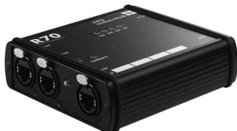
Das R70 Ethernet auf CAN Interface ist mit zwei RJ 45 CAN-Anschlüssen, einem LAN-Anschluss sowie einem integrierten, zuschaltbaren Abschlusswiderstand ausgestattet. Das R70 Interface benötigt keine eigenen Treiber. Die Konfiguration kann über das integrierte Web-Interface mit einem Standard-Web-Browser vorgenommen werden. Hierzu muss Java-Script im Browser aktiviert sein.
