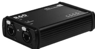
Das R60 USB auf CAN Interface ist mit zwei RJ 45 CAN-Anschlüssen sowie einem integrierten, zuschaltbaren Abschlusswiderstand ausgestattet und wird mit Treibern für Windows® geliefert. Die notwendigen Treiber finden sich zudem im R1 Installationsverzeichnis unter z.B.:
